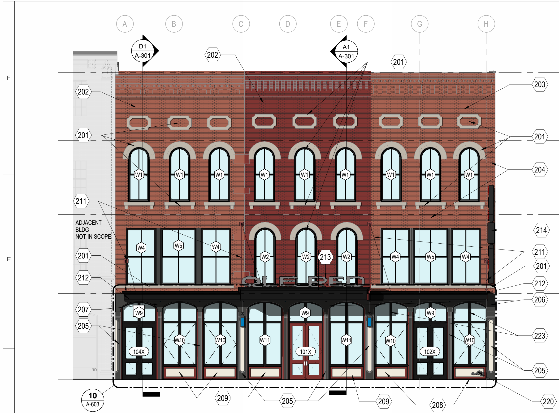
D1 EXTERIOR ELEVATION - WEST 1/8" = 1'-0"
